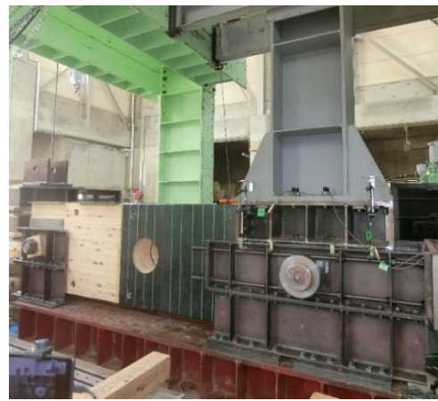
【実大実験の様子(左:二方向ラーメン柱、右:木梁端部仕口の炭素繊維補強)】
