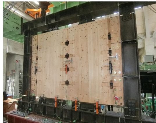
【実大実験の様子(左:スリーブ付き継手梁のクリープ試験、右:ローリング・コッター耐力壁)】
