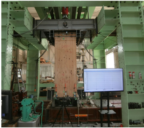
【実大実験の様子(左:二方向ラーメン柱、右:木梁端部仕口の炭素繊維補強)】
