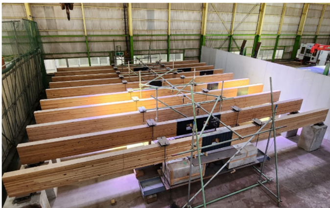
【実大実験の様子(左:スリーブ付き継手梁のクリープ試験、右:ローリング・コッター耐力壁)】
