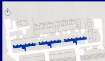
長大板状住棟の一部を切り取って、3つの住棟に分割し、それぞれの棟に新たにエレベーターを設置した例
